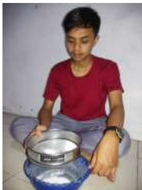
5. Mengayak Cangkang Ukuran Mesh 200
