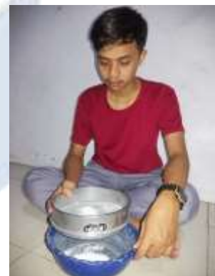
6. Mengayak Cangkang Ukuran Mesh 150
