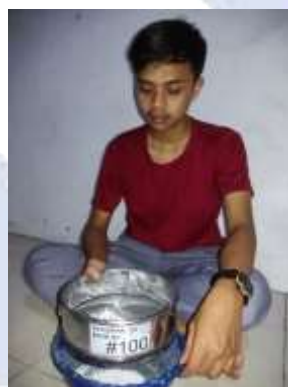
5. Mengayak Cangkang Ukuran Mesh 100
