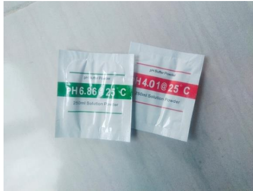
Gambar 3. 18 Kalibrasi pH meter
