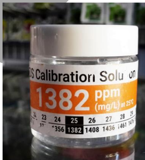
Gambar 3. 19 Kalibrasi TDS meter
