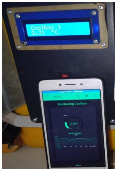
Gambar 4.28 Tampilan Hasil Pengujian Sistem Monitoring Suhu Menggunakan Media Pendingin Es Batu dengan Ikan
