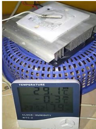
Gambar 4.11 Pengujian Modul Peltier 12706
