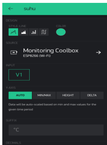
Gambar 4.20 Pengaturan Datastream Suhu yang diukur
