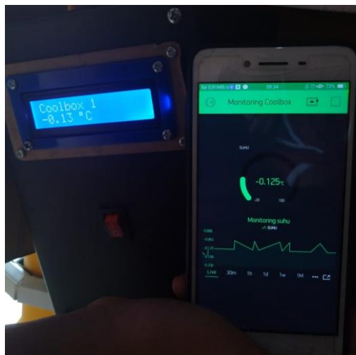
Gambar 4.26 Tampilan Hasil Pengujian Sistem Monitoring Suhu Menggunakan Media Pendingin Es Batu, Ice Gel , dan Thermoelectric Cooler (TEC) tanpa Ikan
