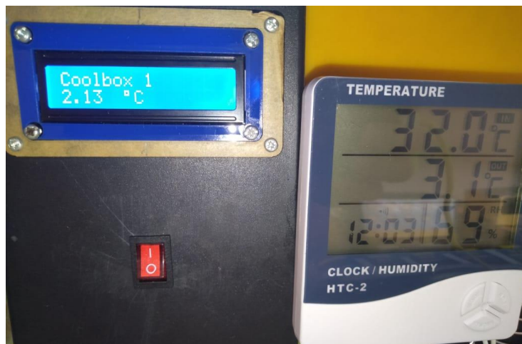
Gambar 4.8 Hasil Pengujian Sensor Suhu DS18B20
