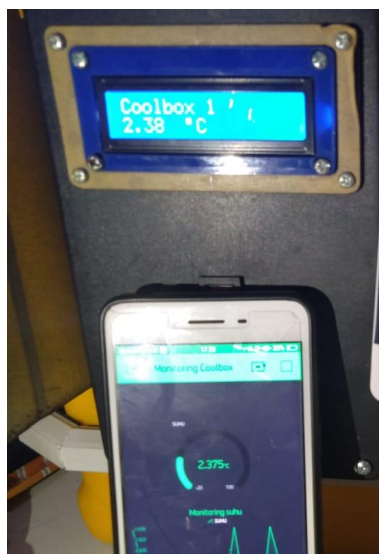
Gambar 4.22 Tampilan Hasil Pengujian Sistem Monitoring Suhu Menggunakan Media Pendingin Es Batu tanpa Ikan
