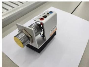
Gambar 2.5 Sensor Analog Induktif
