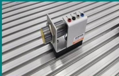
Sensor analog induktif memiliki prinsip kerja yang sama dengan sensor proximity induktif. Hanya saja keluaran dari sensor analog induktif adalah berupa tegangan (0 - 10 VDC) atau berupa arus (4-20 mA). Dan jarak pengukurannya atau jarak sensing mencapai 2 inci tergantung dari tipe sensor yang digunakan.
