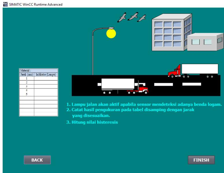
Gambar 4.10 Layer Pengukuran Dengan Sensor *Proximity* Induktif
