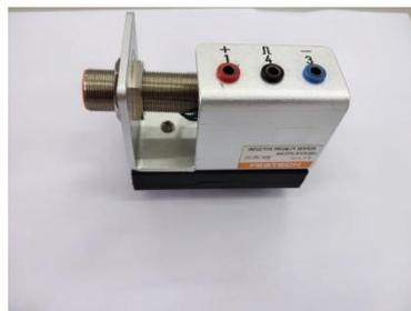
Gambar 2.3 Sensor *Proximity* Induktif M18
