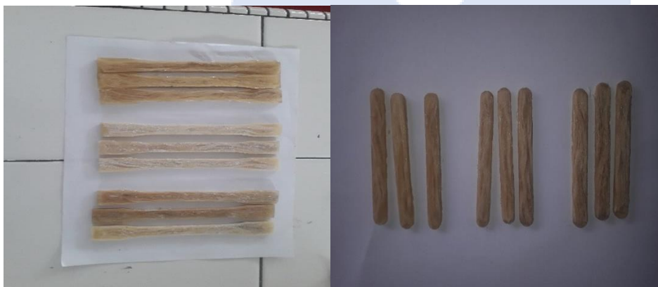
Gambar spesimen uji tarik dan impak yang sudah selesai
