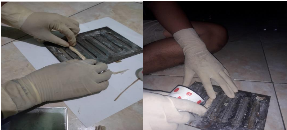
Proses pemasangan serat dan penuangan resin ke cetakan
