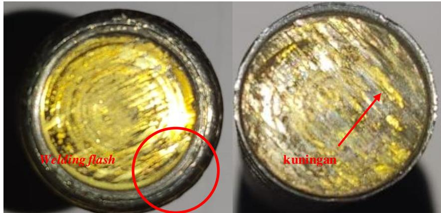
Gambar 4. 8 Hasil pengelasan tanpa *free heat* variasi waktu 6 menit
