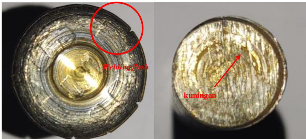
Gambar 4. 13 Hasil pengelasan dengan *free heat* dengan variasi waktu 8 menit
