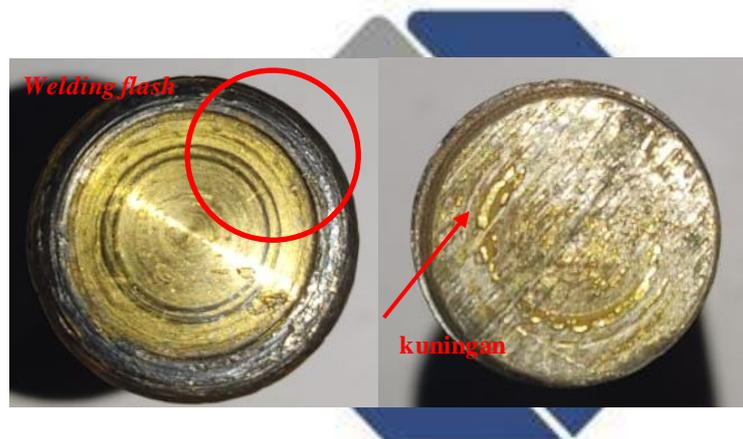
Gambar 4. 11 Hasil pengelasan dengan *free heat* dengan variasi waktu 7 menit
