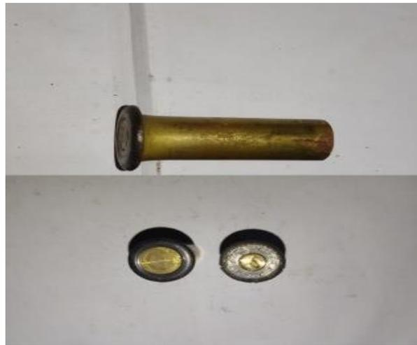
Gambar 4. 17 kuningan setelah proses pengelasan
