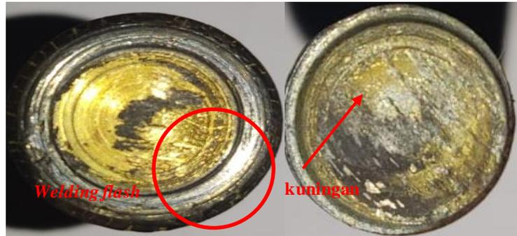
Gambar 4. 10 Hasil pengelasan tanpa *free heat* dengan variasi waktu 7 menit
