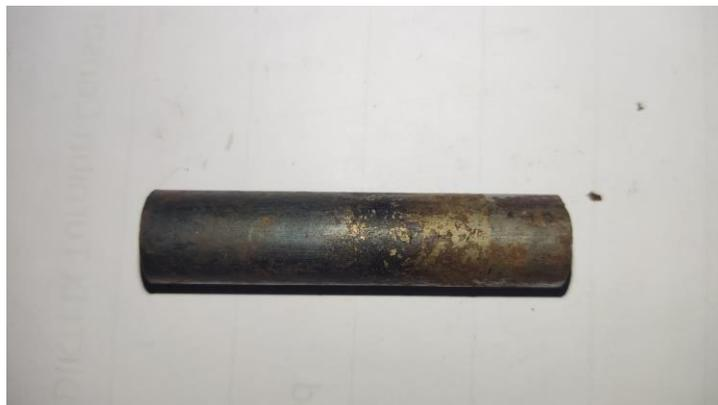
Gambar 4. 15 Tampak samping *AISI 1040* dengan *free heat*
