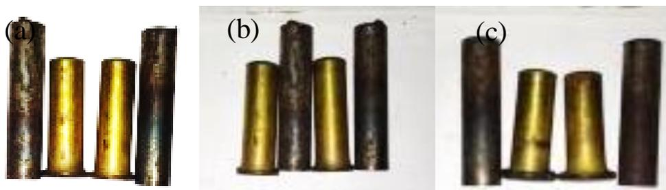
Gambar 4. 6 Hasil pengelasan gesek tanpa *free heat*, (a) waktu 6 menit, (b) waktu 7 menit, (c) waktu 8 menit
