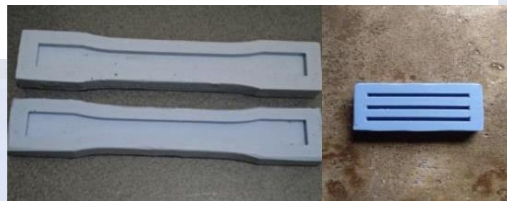
Gambar 3. 10 Cetakan tarik (a) dan Cetakan impact (b)
