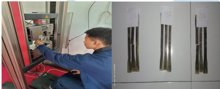
Gambar 4. 1 . a. Proses Pengujian Tarik (kanan) b.Sampel Setelah Diuji (kiri)
