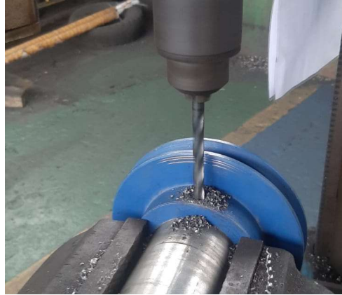
Gambar 3. 9 Proses pembuatan lubang baut tanam
