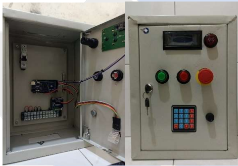
Gambar 3. 12 Layout komponen listrik pada panel
