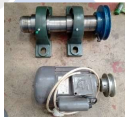
Gambar 3. 10 Shaft dan motor yang sudah terpasang pulley
