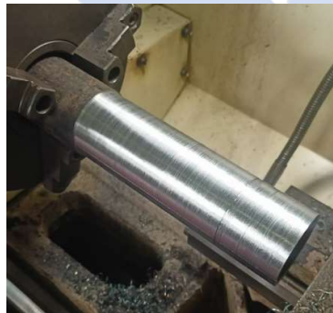
Gambar 3. 8 Proses pembubutan shaft pemotong ring gelas plastik
