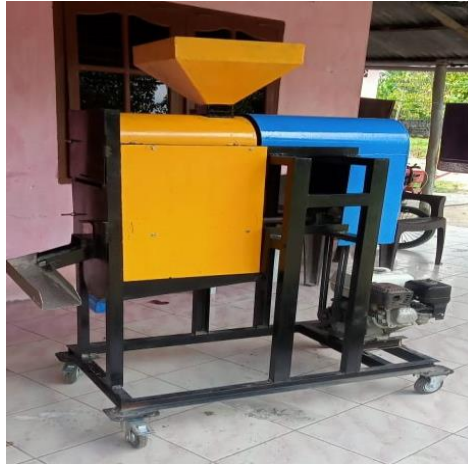
Gambar 4.21 Mesin penyosoh kulit sorgum dengan sistem horizontal bertingkat.
