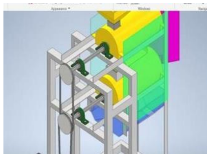
Gambar 4.17 Pemasangan puli dan poros.
