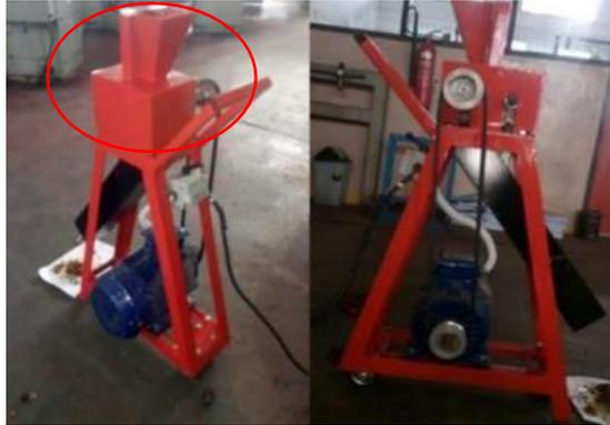
Gambar 2. 1 Mesin Pencacah Brondol Sawit Tahun 2018
