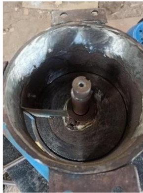
Gambar 4.13 Pemasangan Pisau Pemetong
