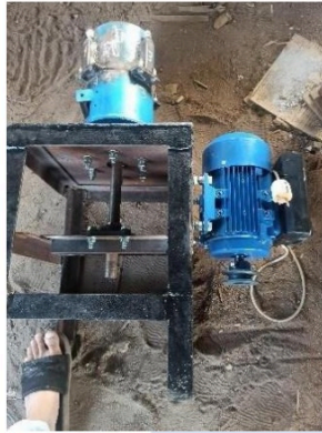
Gambar 4.18 Pemasangan Pulley Kecil
