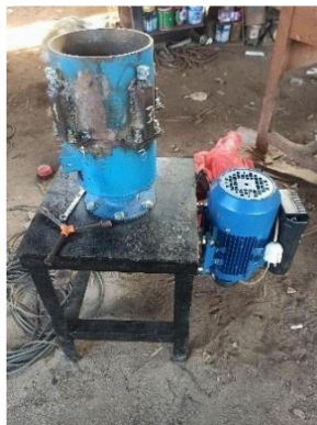
Gambar 4.17 Pemasangan Motor Listrik
