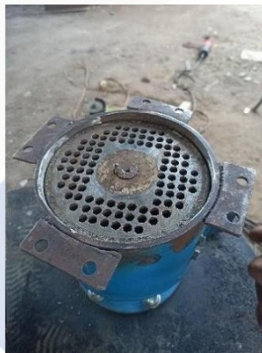
Gambar 4.14 Pemasangan Pelat Pencetak
