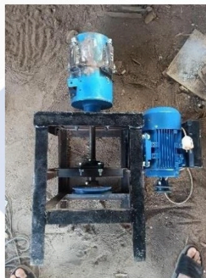
Gambar 4.19 Pemasangan Pulley Besar
