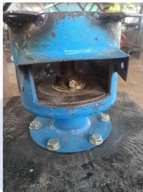
Gambar 4.12 Pemasangan Pelat Pembawa
