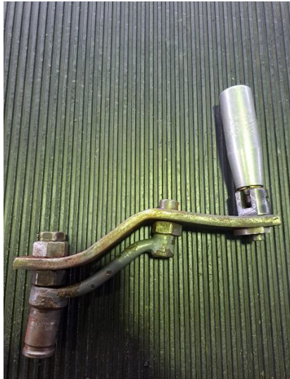
Gambar 4.7 Hasil modifikasi engkol penggerak
