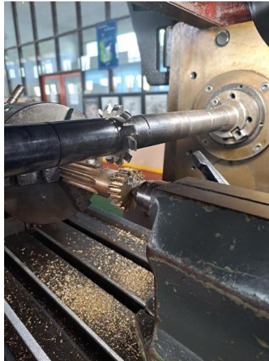
Gambar 4.5 Proses pengefraisan pada roda gigi penggerak ( sprocket )
