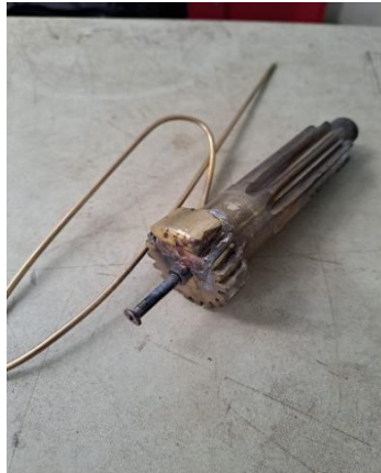
Gambar 4.3 Proses pengelasan roda gigi penggerak ( sprocket )
