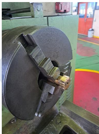
Gambar 4.4 Proses pembubutan roda gigi penggerak ( sprocket )
