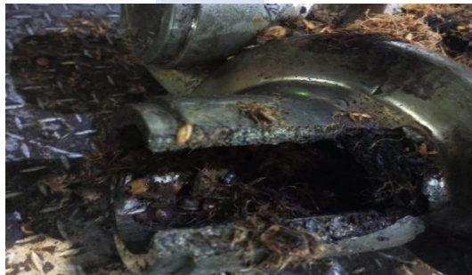
Gambar 4.2 Patah Pada Worm Screw (Sumber: PT. Gunung Maras Lestari, 2023)
