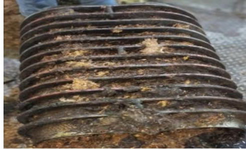
Gambar 4.3 Jebol Pada Press Cage (Sumber: PT. Gunung Maras Lestari, 2023)
