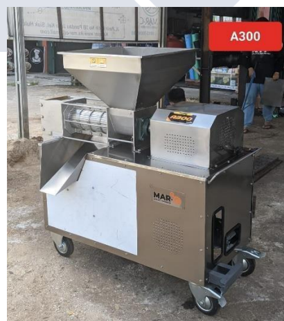
Gambar 1. 1 Mesin pamarut dan pemeras santan
