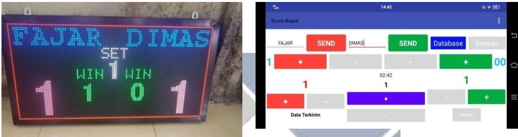
Gambar 4.3 Pengujian Alat dan Tampilan Papan Skor
