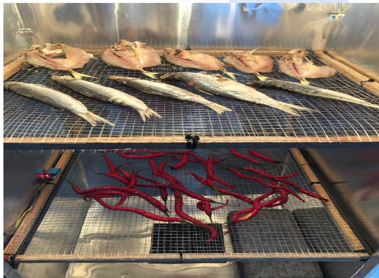
Gambar 4.3 Pengeringan menggunakan metode lampu
