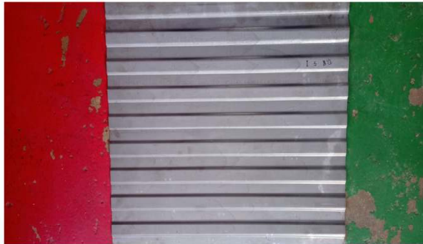
Gambar 4.2 Spesimen Hasil Pengerolan
