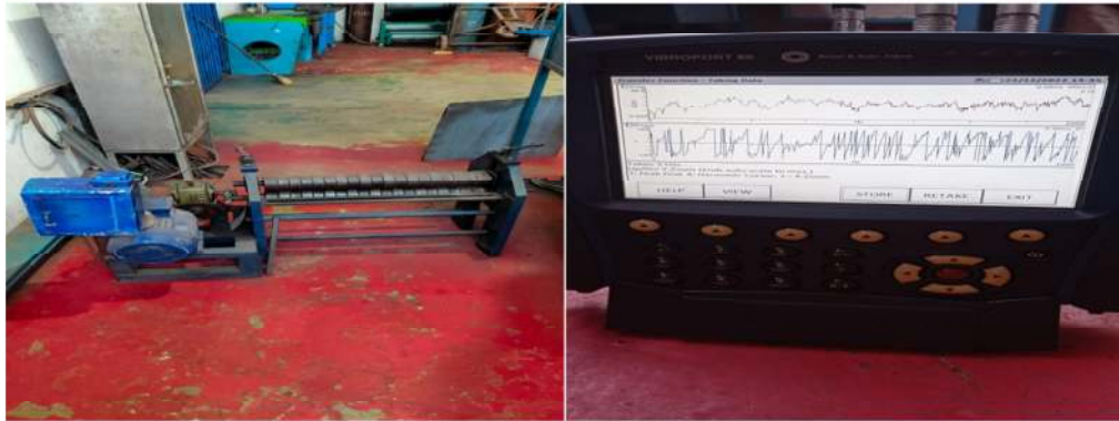
Gambar 3.5 Alat Pengerol Yang Sudah Dibersihkan Dan Kalibrasi Vibroport 80 .
