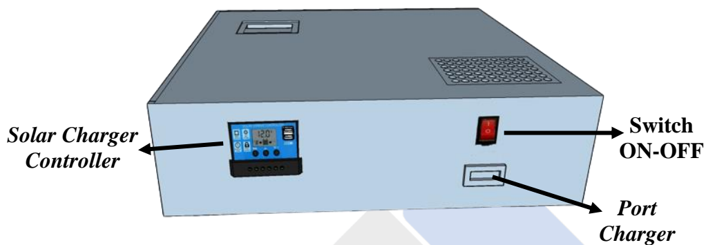
Gambar 3. 5 Desain Box Elektrikal Tampak Depan
