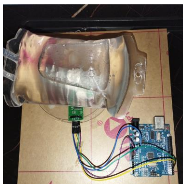
Gambar 4. 12 Pengujian Sensor Loadcell Pada Berat 450 gr
