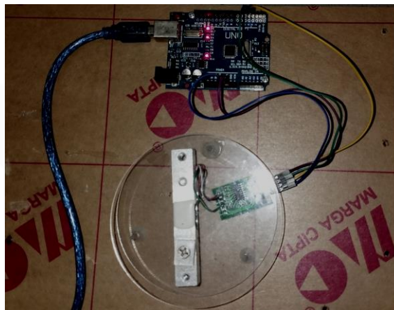
Gambar 4. 10 Rangkaian Sensor Loadcell Dengan Arduino Uno
