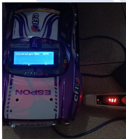
Gambar 4. 24 Hasil Pengujian Sensor Opto-Interrupter terhadap RPM Motor DC
