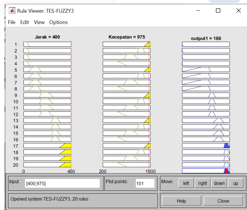
Gambar 4. 37 Simulasi Matlab dengan Nilai Input Jarak 400 dan Input Kecepatan 975
