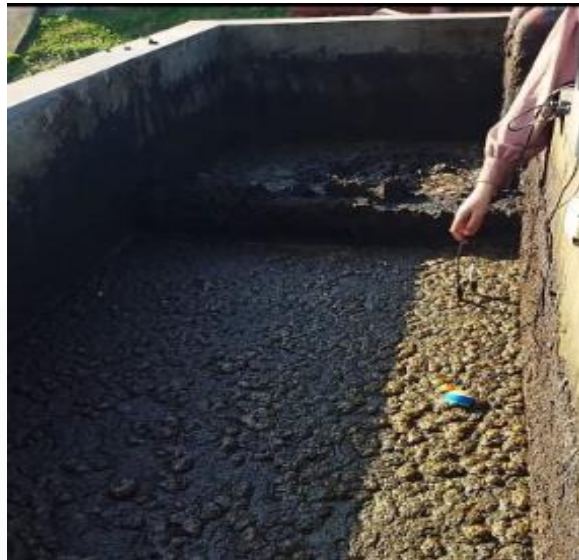
Gambar 4. 21 Pengujian Sensor Suhu DS18B20 Dan Sensor pH 4502C Dan Alat Ukur pH Meter Pada Titik Pertama
