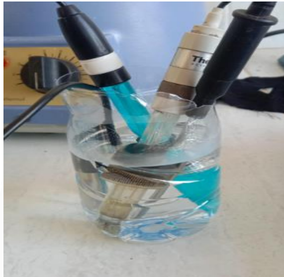
Gambar 4. 15 Pengujian pH Air Menggunakan Alat Ukur pH Meter Dan Sensor pH 4502C
