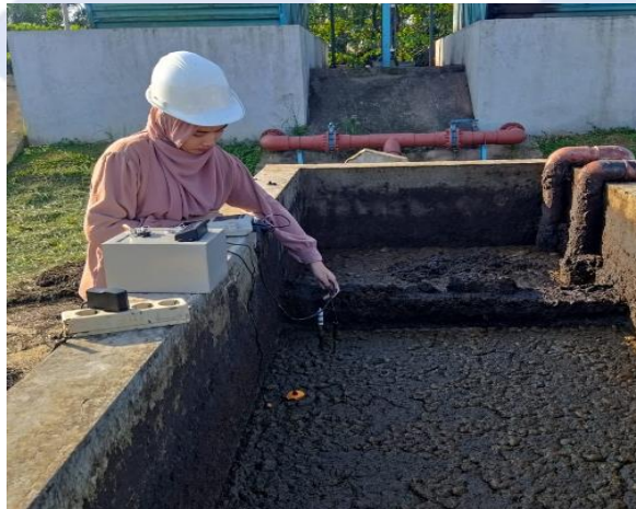
Gambar 4. 24 Pengujian Sensor Suhu DS18B20 Dan Sensor pH 4502C Dan Alat Ukur pH Meter Pada Titik keempat
