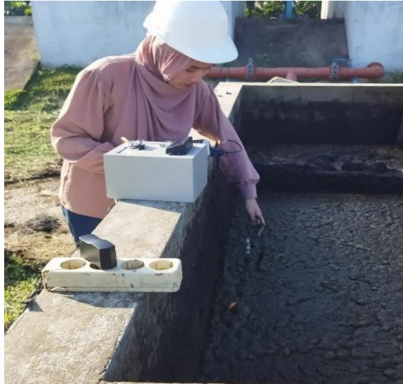
Gambar 4. 23 Pengujian Sensor Suhu DS18B20 Dan Sensor pH 4502C Dan Alat Ukur pH Meter Pada Titik Ketiga
