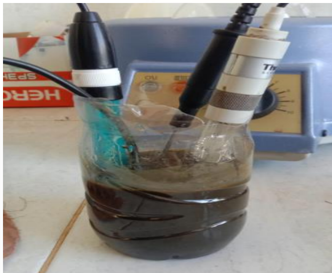
Gambar 4. 14 Pengujian pH Limbah Cair Kelapa Sawit ( POME ) Menggunakan Alat Ukur pH Meter Dan Sensor pH 4502C
