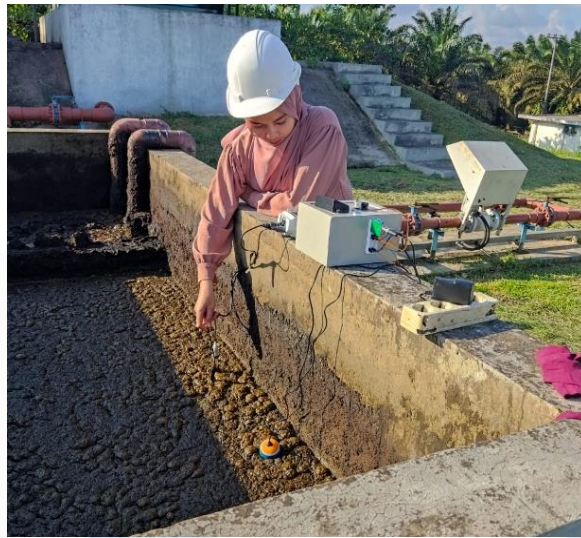
Gambar 4. 22 Pengujian Sensor Suhu DS18B20 Dan Sensor pH 4502C Dan Alat Ukur pH Meter Pada Titik Kedua
