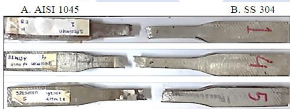
Gambar 4. 2. Spesimen Putus di Area Las
