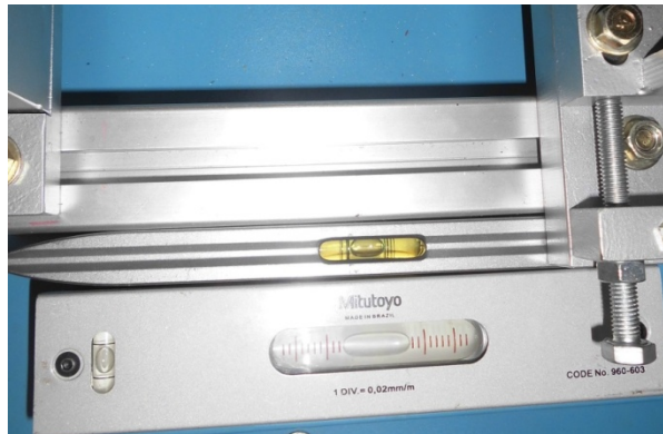
Gambar 4.15. Hasil Verifikasi Kedataran Landasan Meja Mesin
