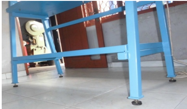
Gambar 4.11 Baut Penyetel Kedataran Meja
