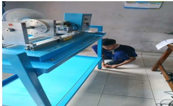
Gambar 4.13 Proses Penyetelan Kedataran Landasan Meja Mesin
