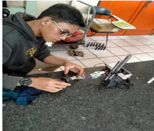
Gambar 3. 11 Proses Pengujian Nilai Kekasaran
