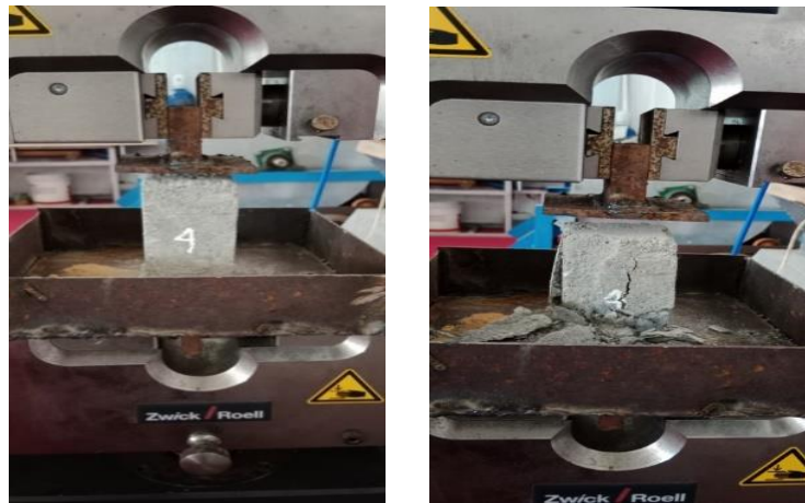
Gambar 4. 14 Bata ringan sebelum dan sesudah dilakukan uji tekan
