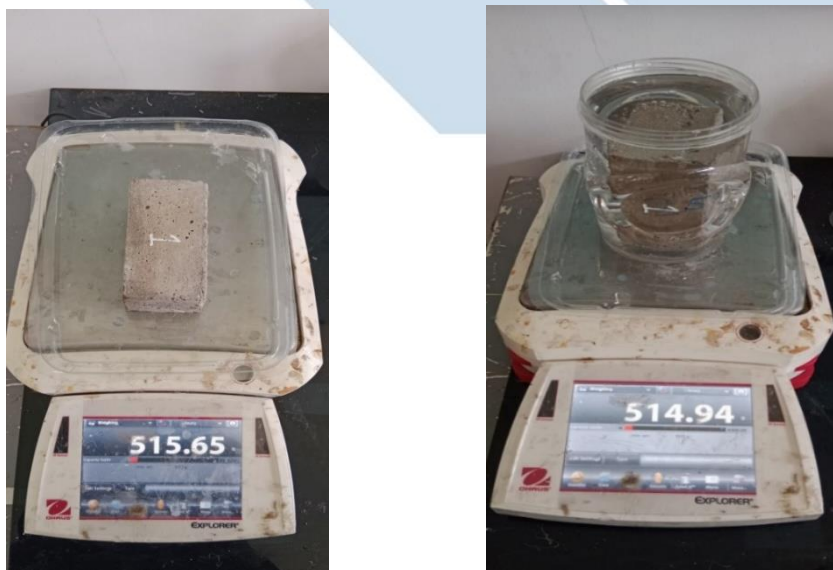
Gambar 4. 6 Sampel bata ringan ditimbang di udara dan di air
