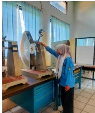
Gambar 4.11Proses Pengujian Impak
