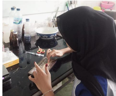
6. Menuangkan campuran resin dan katalis pada cetakan, tunggu spesimen hingga kering atau dijemur dibawah sinar matahari.
