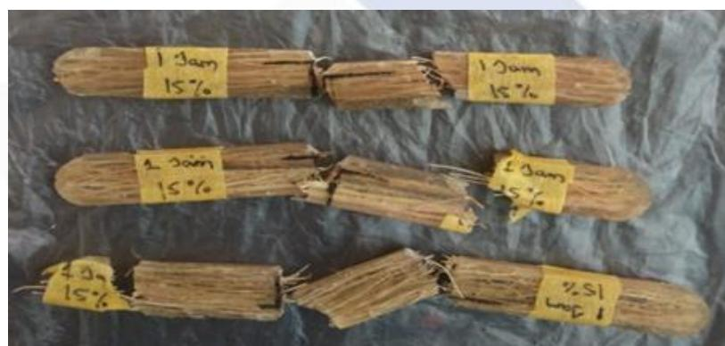
Gambar 4.16 Hasil Deformasi Sampel Nilai Uji Impak Terendah
