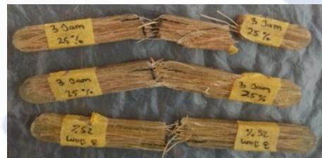
Gambar 4.12Spesimen Setelah Dilakukan Uji Impak
