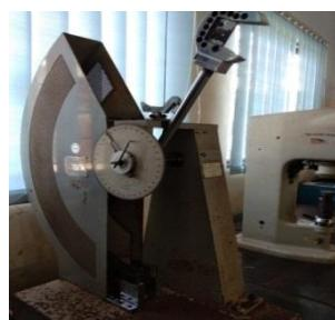
Gambar 3. 14 Alat Uji Impak
