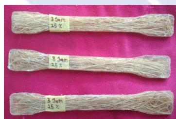
Gambar 4.1 Spesimen Uji Tarik
