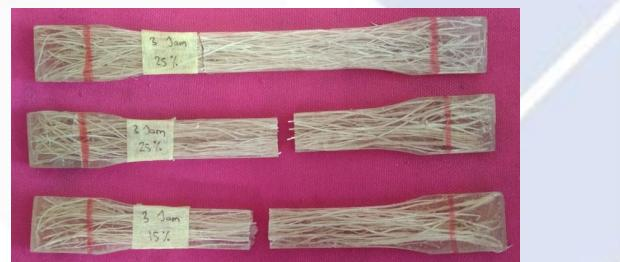
Gambar 4.3 Spesimen Setelah Dilakukan Uji Tarik
