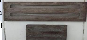
Gambar 3.3 Cetakan Uji Tarik Dan Uji Impak
