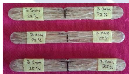
Gambar 4.10 Spesimen Uji Impak
