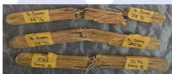
Gambar 4.16 Hasil Deformasi Sampel Nilai Uji Impak Tertinggi
