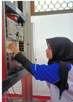
Gambar 4.2 Proses Pengujian Tarik
