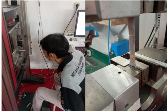
*Gambar 4. 5 Proses Pengujian Tarik Spesimen Uji*
