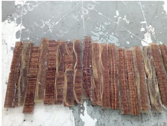
*Gambar 4. 1 Spesimen Uji Impak*
