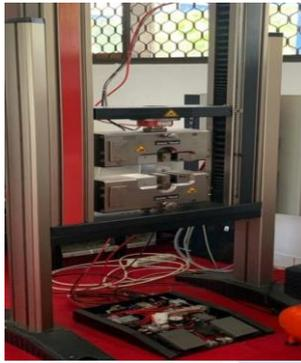
*Gambar 3. 3 Mesin Uji Tarik*
