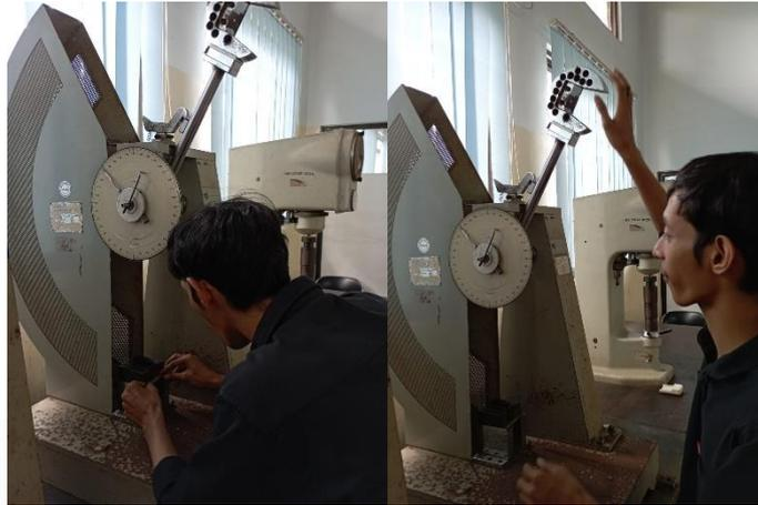
*Gambar 4. 3 Proses Pengujian Impak Spesimen Uji*
