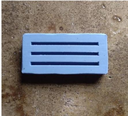
*Gambar 3.4 Cetakan Komposit Uji Impak*
