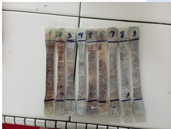
*Gambar 4. 2 Spesimen Uji Tarik*
