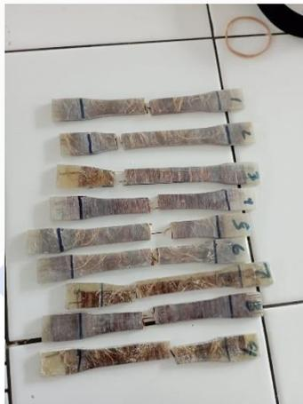
*Gambar 4. 6 Hasil Patahan Pengujian Tarik*
