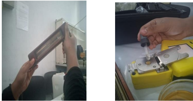
Gambar 3. 16. Pengujian menggunakan visgage dan fluidscan
