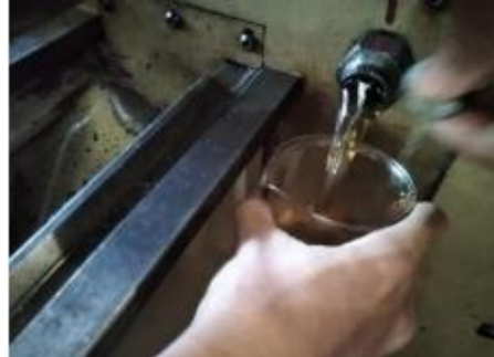
Gambar 3. 13 Pengambilan sampel pelumas melalui pipa atau keran
