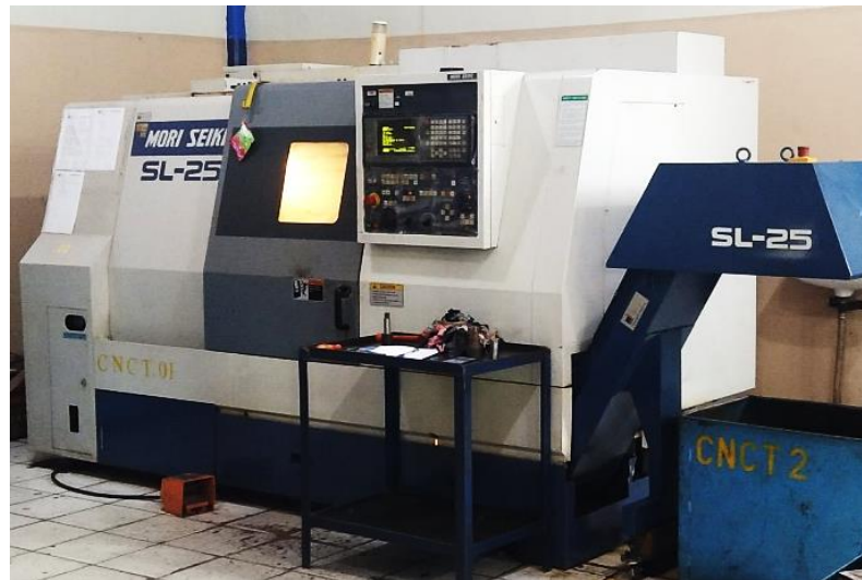
Gambar 3. 2. Mesin Bubut CNC MORI SEIKI SL-25
