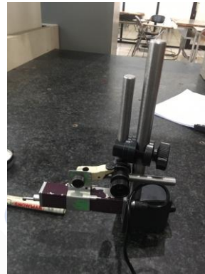
Gambar 3. 14 Alat Pendukung V-Block dan Holder Dial
