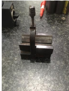
Gambar 3. 14 Alat Pendukung V-Block dan Holder Dial
