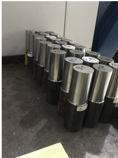
Gambar 3. 13 Benda kerja setelah Proses Pemesinan Bubut CNC
