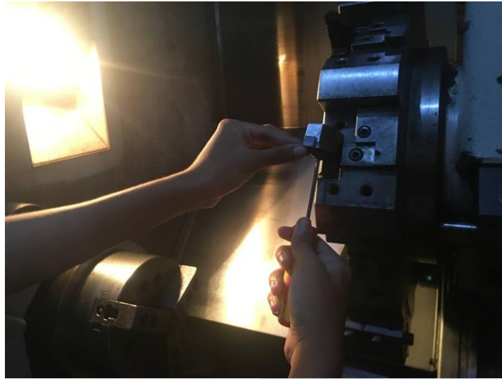
Gambar 3. 11 Pemasangan Insert Carbide CNMG
