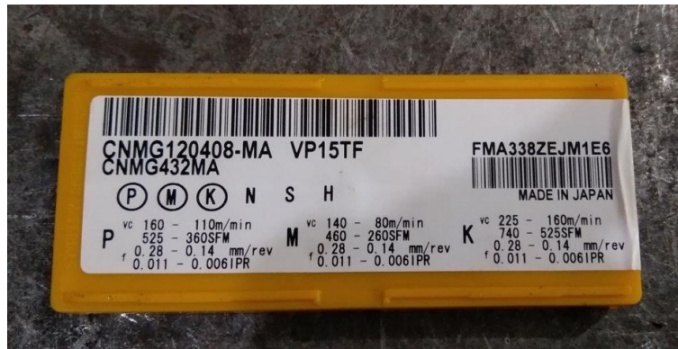
Gambar 3. 4 Spesifikasi Mata Potong Insert Carbide
