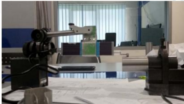
Gambar 3. 16 Seting Pengukuran Benda Kerja Pada Alat Ukur
