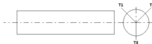
Gambar 3. 18 Gambar Tahap Pengujian Kekasaran Benda Kerja
