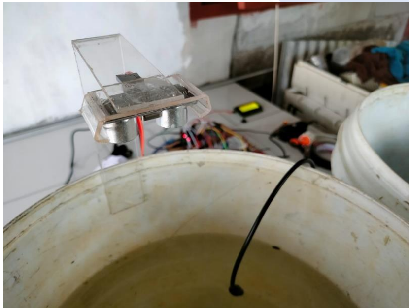
Gambar 4.7 Letak Sensor Ultrasonik dan Sensor TDS Pada Tangki Pencampuran Nutrisi
