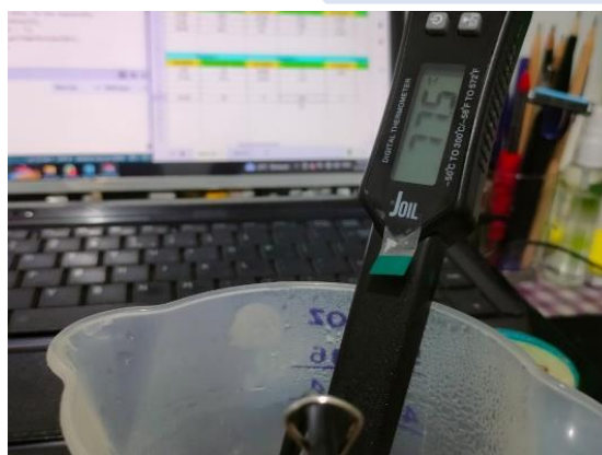
Gambar 4.15 Pengujian Sensor DS18B20 pada Suhu Air 7,75 Derajat Celcius
