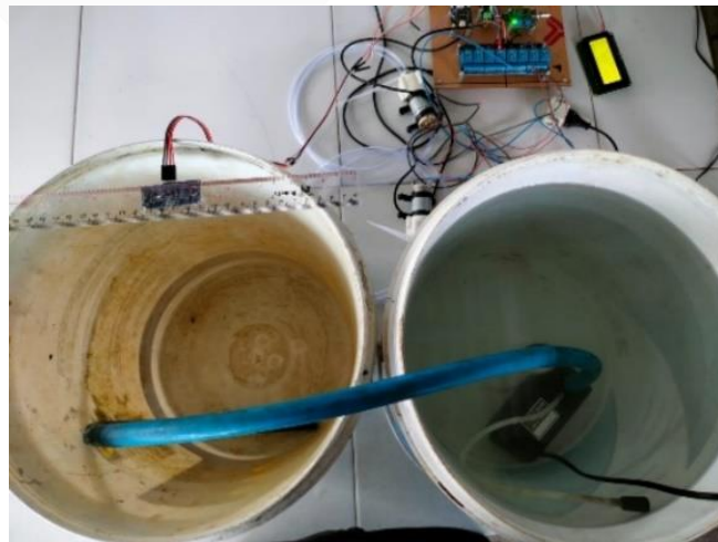
Gambar 4.23 Pengujian Kontrol Ketinggian Air dan Nutrisi
