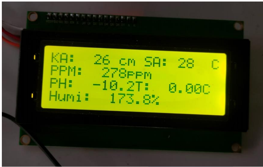
Gambar 4.8 Hasil Monitoring Data Sensor Pada LCD 20x4
