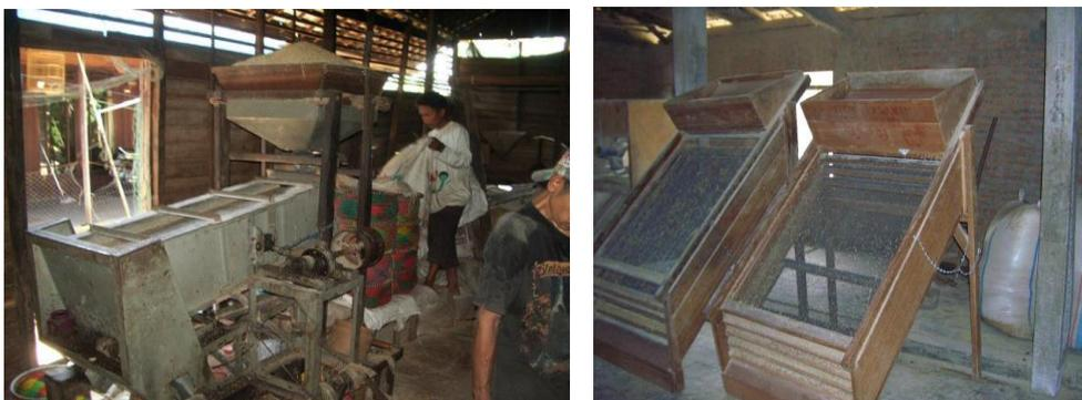
Gambar 2.6 Mekanis kapasitas kecil dan separator manual
