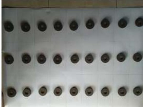
Gambar 4. 3 Spesimen komposit Al/SiO<sub>2</sub>
