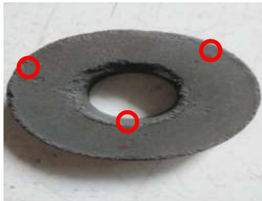
Gambar 4. 7 posisi pengujian kekerasan komposit Al/SiO<sub>2</sub>
