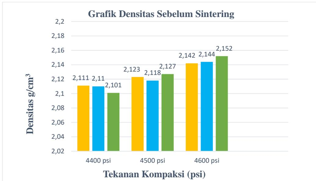
Gambar 4. 6 grafik hasil pengujian densitas sebelum sintering
