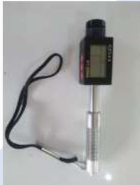
Gambar 3.12 alat uji kekerasan portabel
