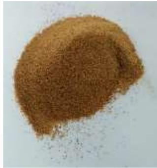
Gambar 3. 3 Pasir silika tailing tambang timah
