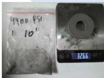
Gambar 4. 4 Penimbangan Spesimen Kondisi Kering
