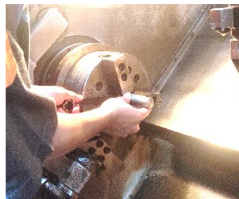
Gambar 4. 5. Pencekaman benda kerja pada chuck
