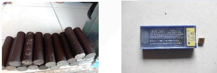
Gambar 4. 1. Benda kerja S45C dan Insert carbide
