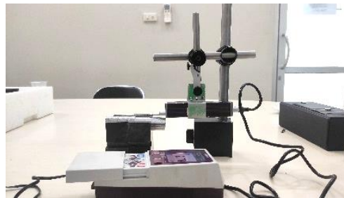
Gambar 4. 11. Proses pengukuran menggunakan surface roughness tester
