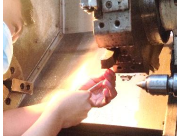
Gambar 4. 6. Pemasangan insert carbide
