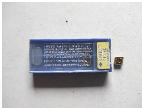
Gambar 3. 3. Insert Carbide CNMG 090308N-UX
