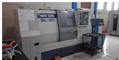
Gambar 3. 2. Mesin CNC bubut Mori Seiki SL-25B/500
