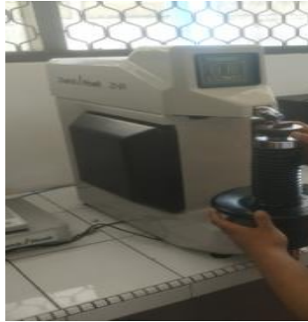
Gambar 4. 9 Melakukan proses pengujian kekerasan
