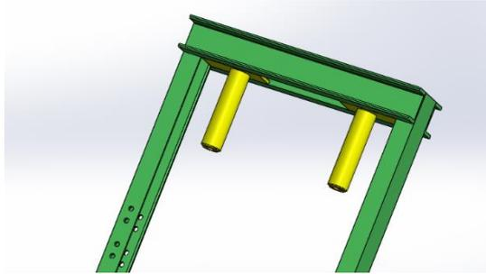
Gambar 4. 19 Perakitan Dudukan dan Pipa Poros Pengarah Dongkrak Atas
