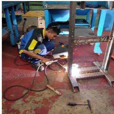
Gambar 4. 15 Proses Pengelasan
