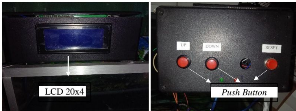
Gambar 4. 6 Pemasangan LCD dan Push Button
