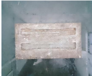
Gambar 3. 8 Cetakan Uji Tarik (ASTM D638)
