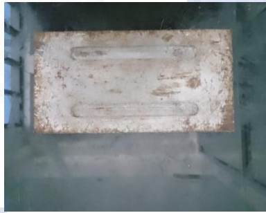
Gambar 3. 9 Cetakan Uji Lentur ( ASTM D790)
