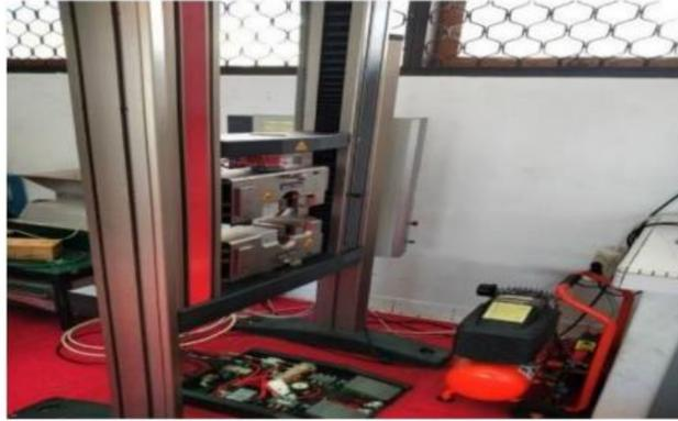
Gambar 12. Mesin Uji Tarik *Zwick Roell*
