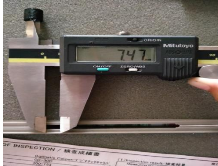
Gambar 4.5 Pengukuran Diameter Dalam Spesimen
