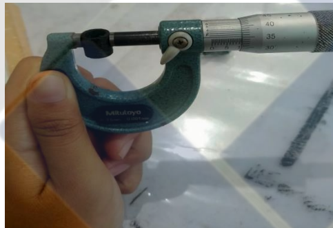
Gambar 4,3 Pengukuran Diameter Luar Spesimen
