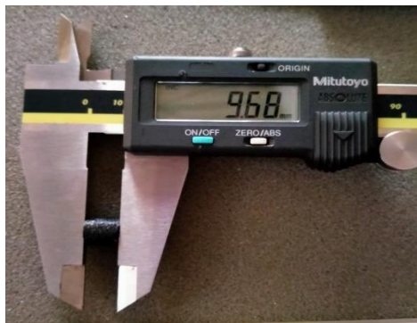
Gambar 4.4 Pengukuran Tinggi Spesimen
