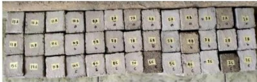
Gambar 4. 1 Hasil sampel bata ringan dengan 3 kali replikasi
