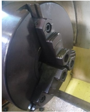
Gambar 2. 3 Chuck pada Mesin Bubut Krisbow Tipe AOB2 – 25 Model CDL6241
