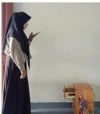
Gambar 4. 21 Pengujian Jarak dan Respon Laci Terhadap Perintah Suara
