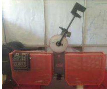
Gambar 4.8 Mengatur beban alat uji
