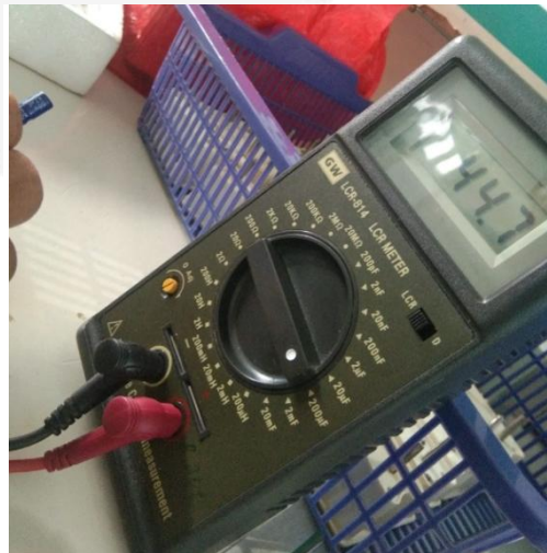
Gambar 4.8 Pengukuran Kapasitor LCR
