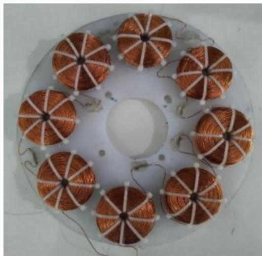
Gambar 3.4 Bentuk konstruksi Stator
