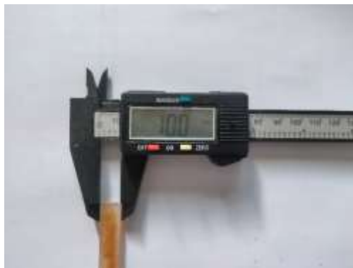
Gambar 4.25 Pengukuran Spesimen Uji Tarik
