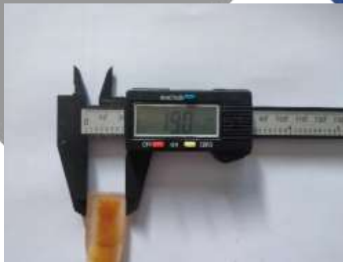
Gambar 4.24 Pengukuran Spesimen Uji Tarik
