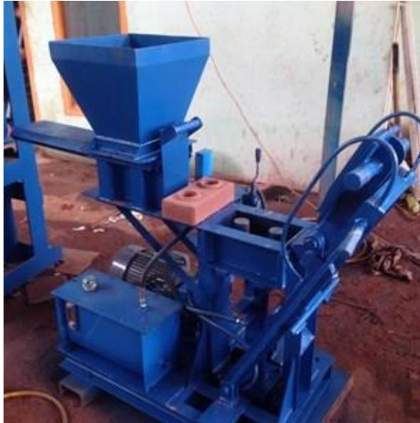
**Gambar 2.2** Mesin pencetak Batako *Interlocking* (PT. Kembar Teknik, 2015)
