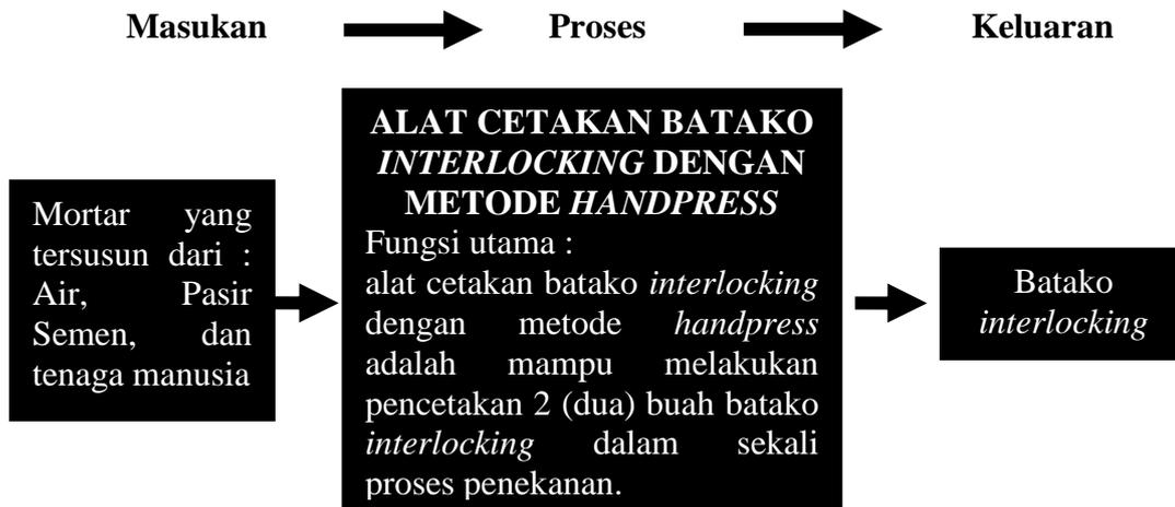
Gambar 4.1 Diagram Blok Fungsi
