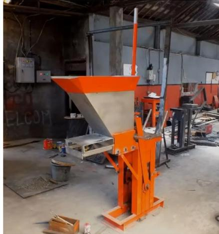
**Gambar 2.3** Alat pencetak Batako *Interlocking* (PT. Kembar Teknik, 2015)
