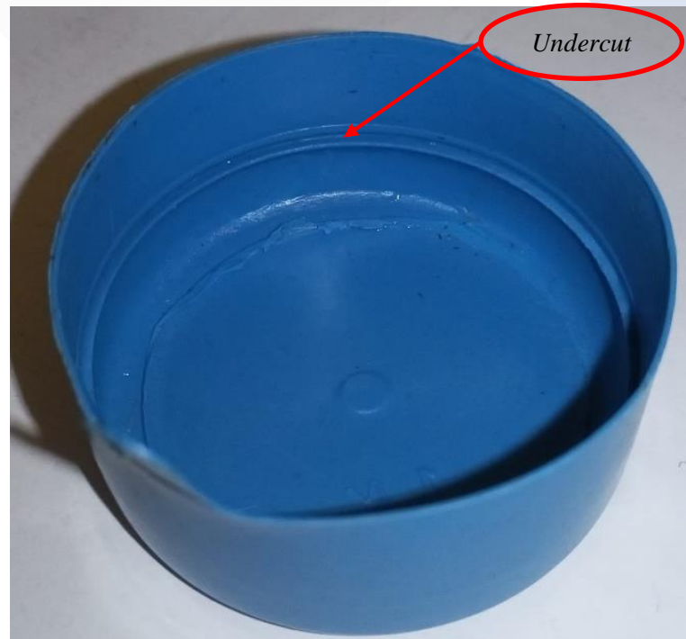
Gambar 4.1 Undercut Produk Tutup “Galon” Air Minum
